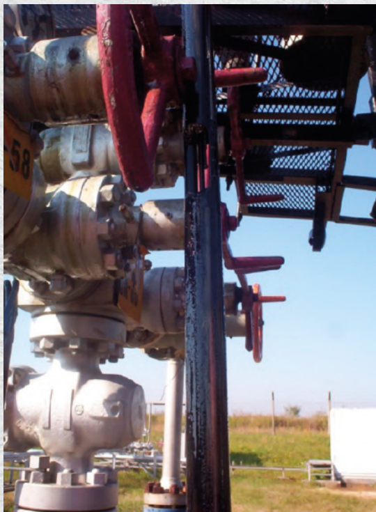
Slika 6. Izgled sonde po izlasku iz bušotine u kojoj postoji pomiješano ulje s vodom na dnu
