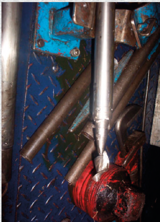
Slika 7. Izgled sonde izvađene iz bušotine nakon instrumentacije (oštećen propeler)
